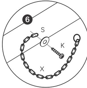
**Passo 1:** Parafusar a corrente (X) com os parafusos (K) junto com arruela (S) no Chapéu (6).
