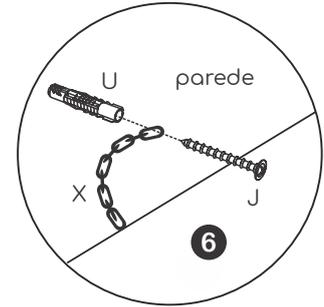
**Passo 2:** Furar a parede com broca Ø8mm e instalar as buchas (U). Posicionar o produto junto à parede e em seguida fixar a corrente na parede com o parafuso (J).
