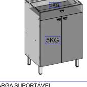
CARGA SUPORTÁVEL O PESO MÁXIMO DE CARGA INFORMADO NO DESENHO ACIMA REFERE-SE A OBJETOS DISTRIBUÍDOS DE MANEIRA UNIFORME SOBRE TODA A ÁREA DE CONTATO DA PEÇA. 5309 - MANUAL BAL INF KIT 70 VERONA PAGINA 1 DE 4. VERONA BAL INFERIOR KIT
