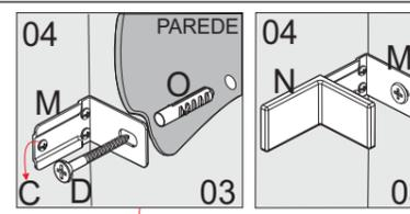
FIXE PRIMEIRO PELOS 03 FUROS MENORES EXISTENTES NO SUPORTE, QUE FICARÃO NAS LATERAIS DO MÓVEL (04), UTILIZANDO 02UN DO PARAFUSO (C) 3,5X14MM PARA CADA SUPORTE.
