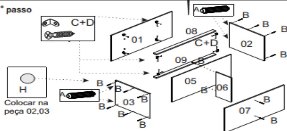
A peça N°1 é fixada na parte final deste 1º passo, após montar todas as demais peças.
