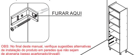
OBS: No final deste manual, verifique sugestões alternativas de instalação do produto em paredes que não sejam de alvenaria (gesso acartonado/drywall)
