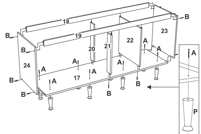
**05** - Fixar os fundos na parte inferior do móvel utilizando os pregos I, fixar as cantoneiras L para fixar o tampo na lateral e travessas utilizando os parafusos C.
