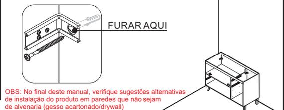
OBS: No final deste manual, verifique sugestões alternativas de instalação do produto em paredes que não sejam de alvenaria (gesso acartonado/drywall)
