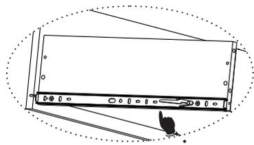
**Fixar a corredeira zerando na parte de baixo da lateral de gaveta, posicione e fixe diretamente com o parafuso (10649).**
