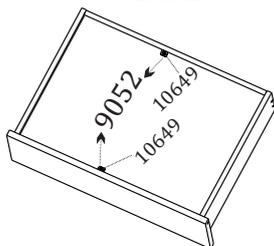
**Obs: Coloque o suporte triangular (9052) no fundo de gaveta, para aumentar sua sustentabilidade utilizando o parafuso (10649).**
