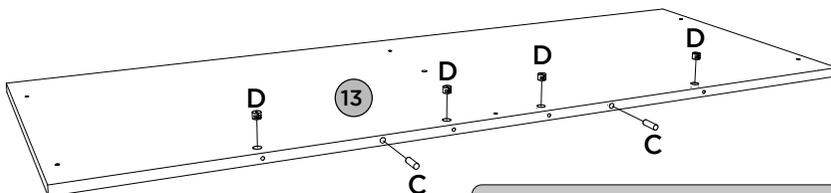
Se o Kit (O967-64) for adquirido, é necessário inserir a porca cilíndrica (D) e a cavilha (C) no Tambo (13) antes de ser fixado ao produto.
