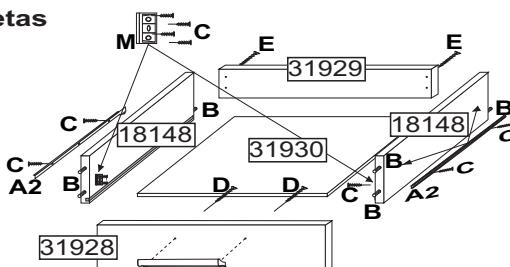
**Gavetas** - Parafusar as laterais de gaveta (18148) ao lenço da gaveta (31929) com o parafuso (E); encaixar o fundo e fixar a frente com cantoneira (M); a corrediça (A2) deve ser parafusada na lateral (18148) com o parafuso (C) na posição horizontal como mostra a imagem.
