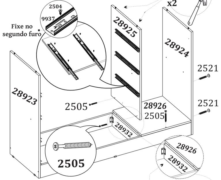
Fixe a cantoneira (2466) na travessa (28932) como demonstra a figura e em seguida, fixe nos rodapés faceando na base de modo que a divisão possa apoiar sobre ela.
