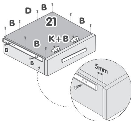
**É indispensável fixar a corredeça na lateral, com recuo de 5 mm em relação a frente da gaveta, para acionar a trava da corredeça.**
