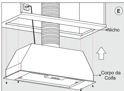
F) Após fixação da coifa ao nicho, realizar as conexões das lâmpadas. Posicionar a moldura na coifa e parafusar os pontos indicados, apertando gradativamente. Não apertar demais para não danificar a moldura. Com a moldura instalada, encaixar o filtro de alumínio.
