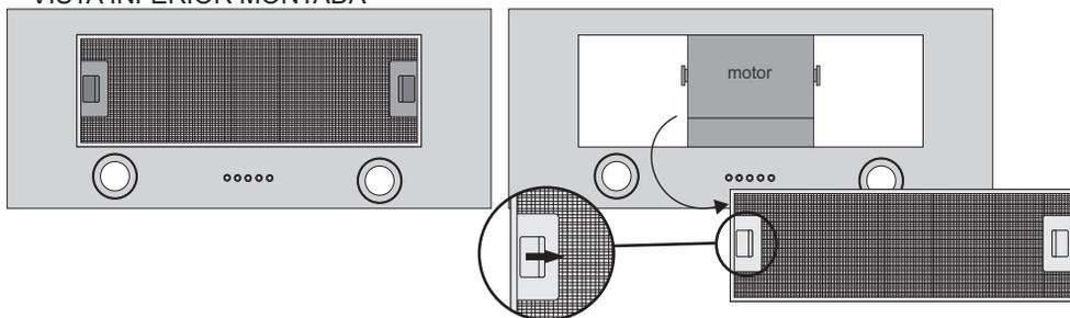
Retirar o filtro de alumínio, com cuidado, puxando através das travas do filtro. Ao retirar o filtro de alumínio o acesso ao interior da coifa estará livre, sendo possível visualizar o motor.
