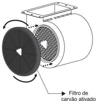
Encaixar os filtros de carvão no motor, girando até travar. Recolocar o filtro de alumínio.
