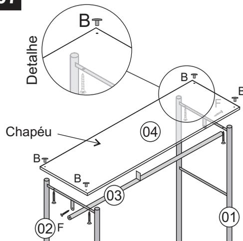
**14** - Una as peças (01) e (02) utilizando a peça (03), com o parafuso (F). (Não aperte totalmente).
