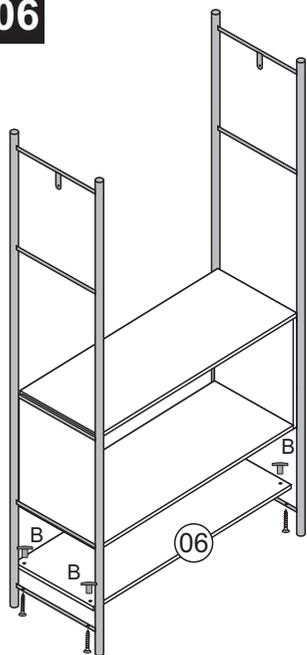
**13** - Parafuse a peça (06), utilizando o C.J. parafuso (B). Não aperte totalmente.
