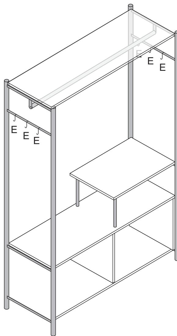
20 - Coloque os ganchos (E) nos orifícios existentes nas laterais do guarda roupa.
