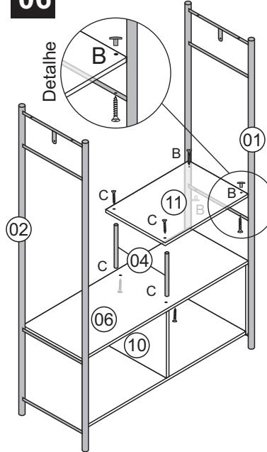
**10** - Parafuse de baixo pra cima a peça (04) no painel superior da caixa, fazendo uso dos parafusos (C), nos orifícios existentes.
