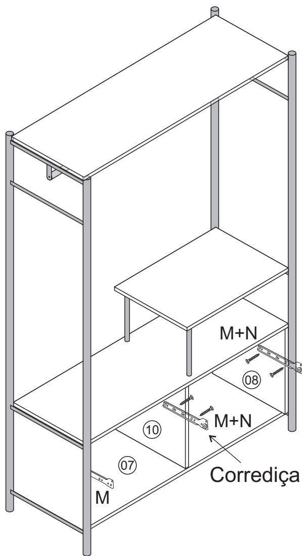
19 - Coloque na parte interna da caixa as corrediças das gaveta (M) parafusando com parafuso (N).
