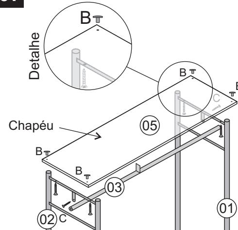
**12** - Una as peças (01) e (02) utilizando a peça (03), com o parafuso (C). (Não aperte totalmente).
