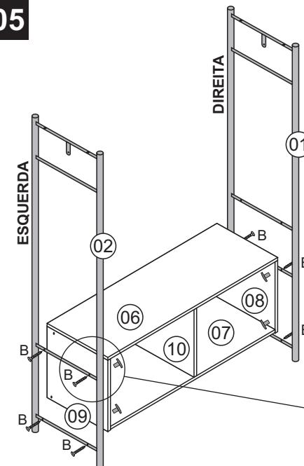
**09** - Parafuse a caixa nas peças (01) e (02), utilizando o CJ. parafuso (B). Não aperte totalmente.
