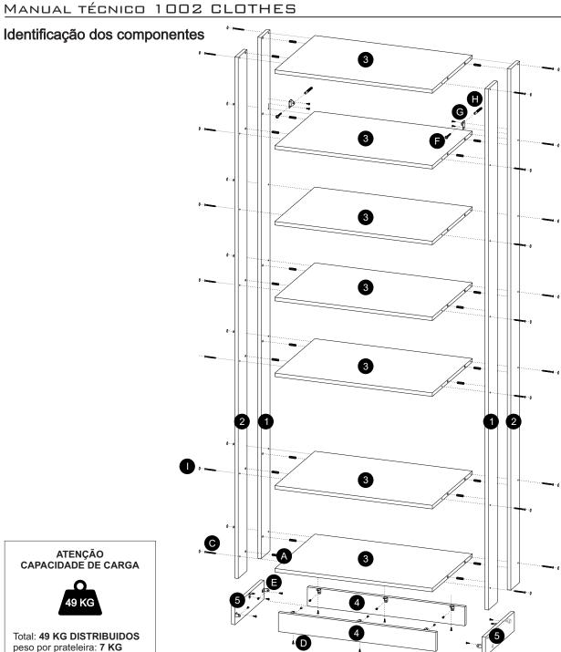
COMPONENTES **FERRAGENS** B A Lateral dir. Cavilha 8x30 mm A B Cola Lateral esq. C 3 Parafuso cabeça chata 4x50 mm O Prateleira 0 Rodapé frontal Parafuso cabeça chata 3,5x14 mm O 8 Chapinha de montagem 0 Rodapé lateral Parafuso cabeça flangeada 4x50 mm 0 G 0 G Chapinha de fixação Bucha 8x40 mm 0
