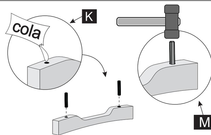
**5º** - RETIRE O EXCESSO DE TECIDO DO FUCO DO ENCOSTO E PASSE COLA, EM SEGUIDA, POSICIONE O DETALHE. PARA FIXAR COLOQUE UM TECIDO SOBRE O DETALHE PARA PROTEGER E BATA LEVEMENTE ATÉ ENCAIXAR AS CAVILHAS NO ENCOSTO.
