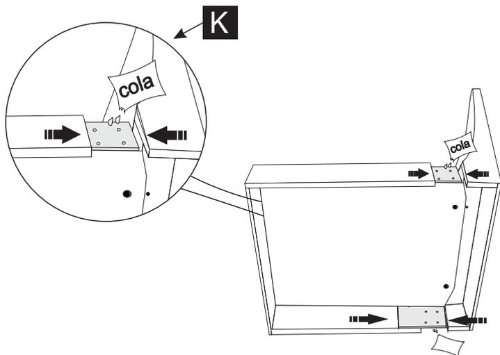
**2º** - UNIR O ASSENTO AO ENCOSTO, UTILIZANDO CHAVE ZETA+PARAF. 07X40 CAB. 17mm. LOGO APÓS, FIXAR A CHAPA (6mm) DO ASSENTO AO ENCOSTO UTILIZANDO PARAF. 3,5X16.
