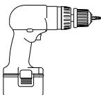
Utilizar a parafusadeira com o torque em 15 para fixar o lastro.
