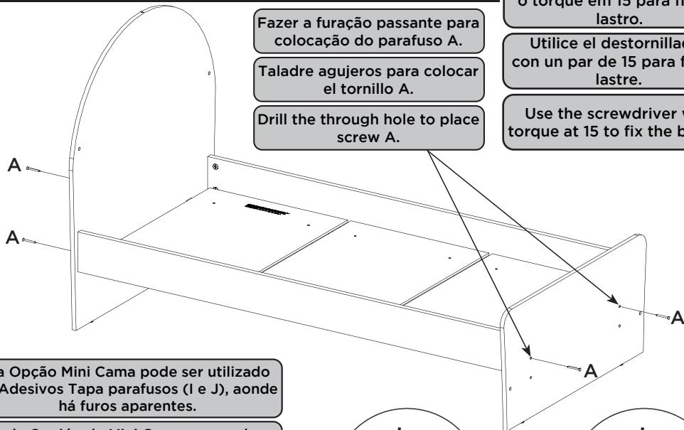
Utilizar a parafusadeira com o torque em 15 para fixar o lastro.
