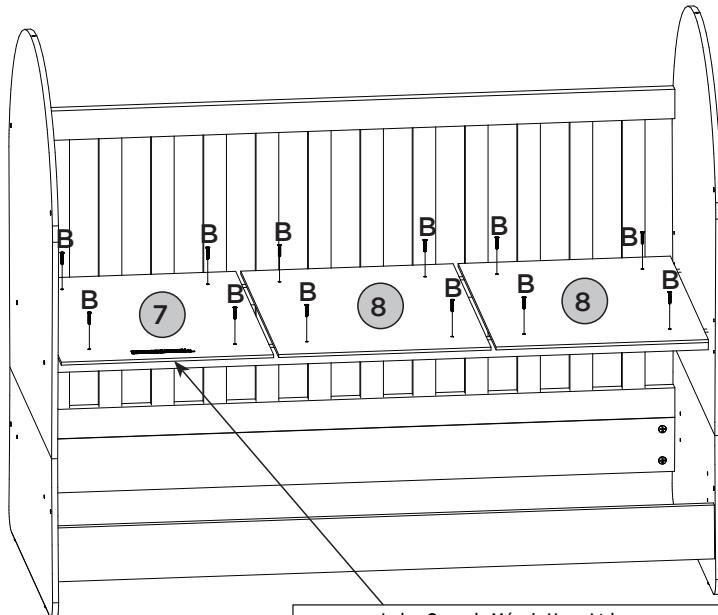
Utilizar a parafusadeira com o torque em 15 para fixar a grade e para fixar o lastro.
