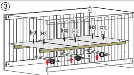
Centralize os reforços na parte de baixo das ripas do estrado e fixe-as com parafusos conforme desenhos acima
