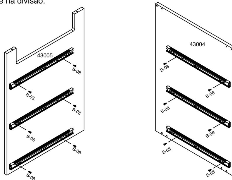
**Passo 2:** Usar cavilhas, parafusos Bigfix e tambores para montagem das laterais c/ as frentes. Usar parafusos B-03 e cavilhas para montagem das laterais c/ os traseiros. Usar parafusos B-08 para fixar o puxador e os trilhos telescópicos.
