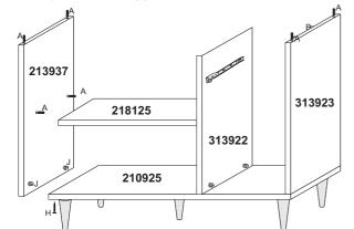
**5º Passo** Fixar fundos 218101 e 218103 usando prego 08 x 08 (K) e fixador de fundo (D), na peça 210935 o fundo deve ser fixado com parafuso 3,5 x 12 (F).
