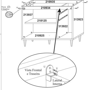
Fixar peça 218135 nas peças 213937 e 313923 usando dispositivo trapézio (B) e parafuso 3,5 x 25 (G) e cavilha de madeira (A).
