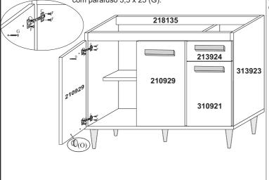
∠ 2º Passo Fixar as corrediças metálicas (R) junto com parafuso 3,5 x 12 (F) nas peças 313922 e 313923. Sendo 6 parafuso em cada lado.
