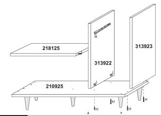
**4º Passo** Fixar as peças 210934 e 210935 nas peças 313923 213937 usando parafuso 4,0 x 45 (H) junto com porca cilíndrica (J). E na peça 313922 usando o dispositivo FL (U) junto com parafuso 4,0 x 16(V).
