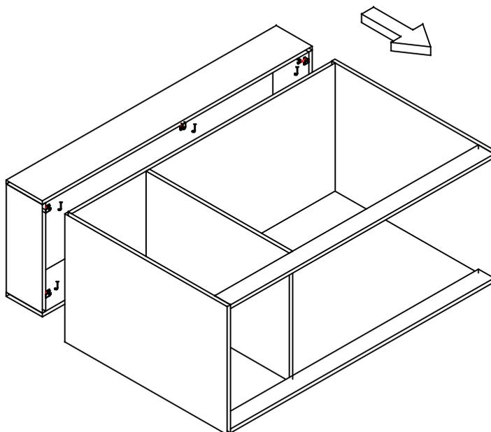
Utilize os parafusos "C" para fazer a fixação das costas na parte superior junto a travessa.
