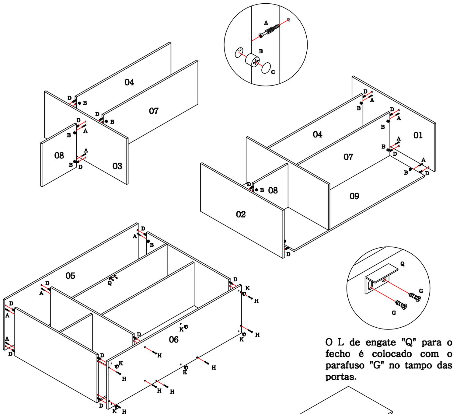
O L de engate "Q" para o fecho é colocado com o parafuso "G" no tampo das portas.
