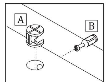
Para a montagem do tampo fixar utilizando minifix.
