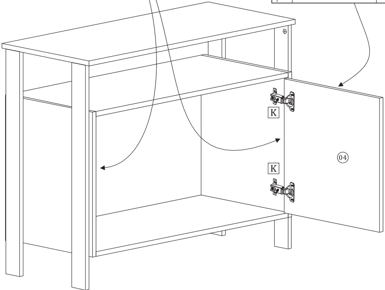
Finalizando a montagem, fixar a travessa com parafusos.
