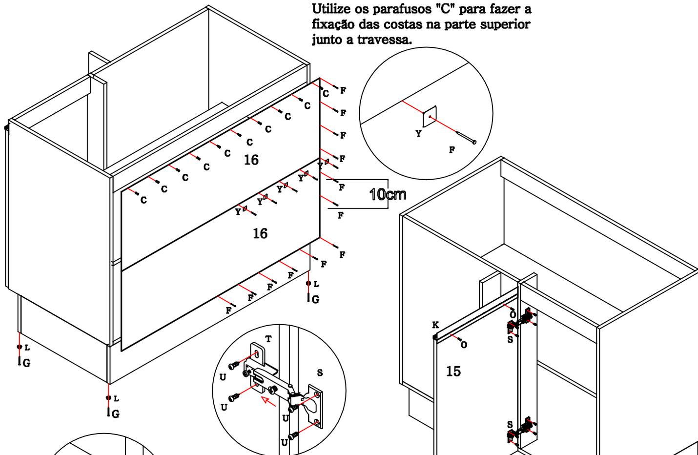
A dobradiça "S" deve ser encaixada no calço "T" e estes colocados com os parafusos "U", observando o procedimento a cima.
