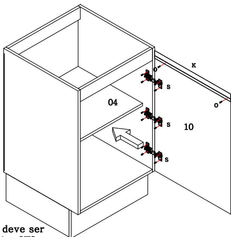
A dobradiça "S" deve ser encaixada no calço "T" e estes colocados com os parafusos "U", observando o procedimento a cima.
