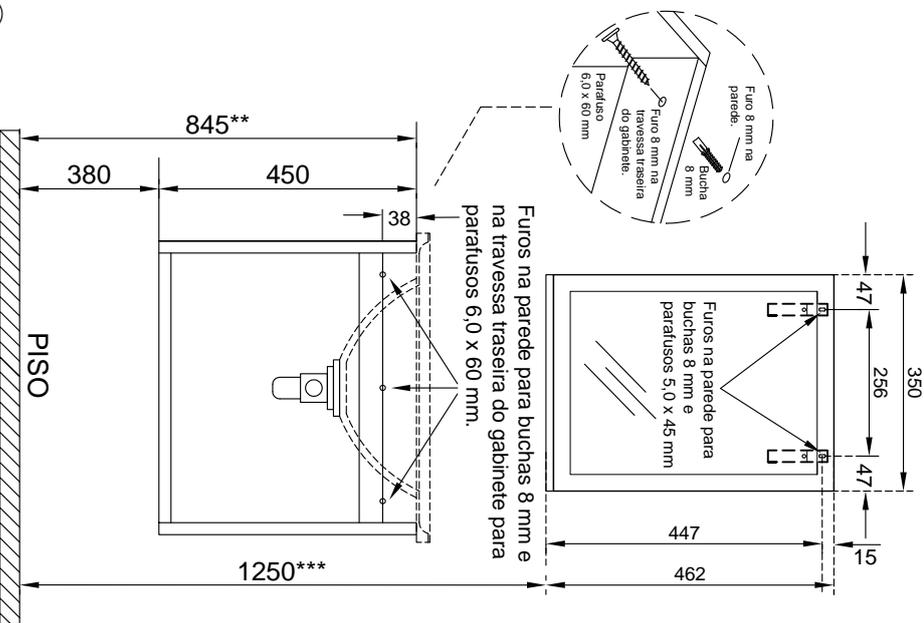
Furos na parede para buchas 8 mm e na travessa traseira do gabinete para parafusos 6,0 x 60 mm.
