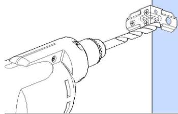
**3.** Fixe os parafusos 6x50 mm nas chapas metálicas que estão fixas dentro do móvel, prendendo o móvel na parede com as buchas.
