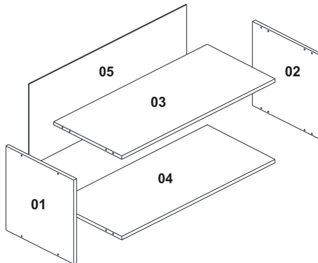
01 - Fixar as laterais, tampo e base utilizando parafusos D e cavilhas A.
