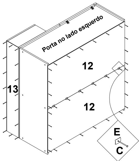
10º - Fixe as molduras lateral, superior e inferior da porta com canntoneira angular e Parafuso Flang PHS 3,5 x 12 c/ pont.
