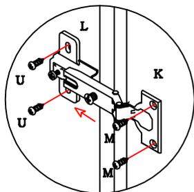
A dobradiça "K" deve ser encaixada no calço "L" e estes colocados com os parafusos "M" na porta e "U" no chapéu, observando o procedimento a cima.
