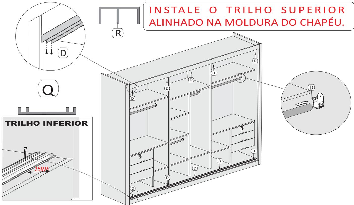
**FIXAR 25MM ATRÁS DO RODAPÉ FRONTAL COM PARAFUSO ( D ) 3,5X14MM**
