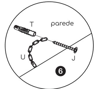
**Passo 2:** Furar a parede com broca Ø8mm e instalar as buchas (T). Posicionar o produto junto à parede e em seguida fixar a corrente (U) na parede com o parafuso (J).
