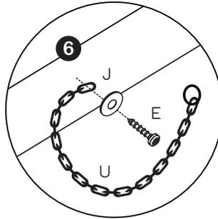
**Passo 1:** Parafusar a corrente (U) com os parafusos (E) junto à arruela (J) no Chapéu (5).
