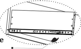
**7** Faça a montagem da porta conforme a orientação abaixo: **Obs: Encaixe o apoio dobradiça (12367) na dobradiça (2481) antes de fixar no furo da porta.**
