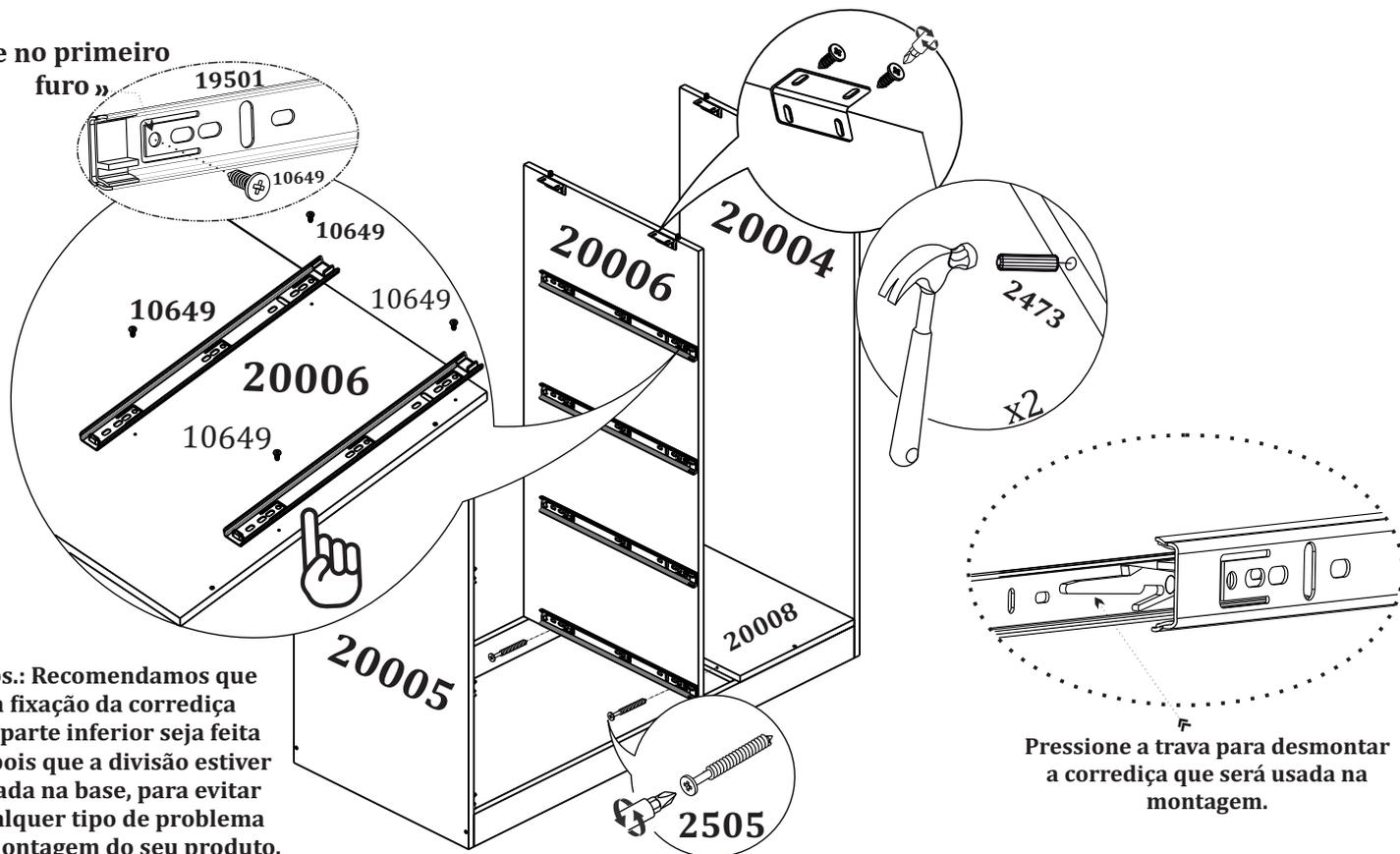
Obs.: Recomendamos que a fixação da corredeira da parte inferior seja feita depois que a divisão estiver fixada na base, para evitar qualquer tipo de problema na montagem do seu produto.
